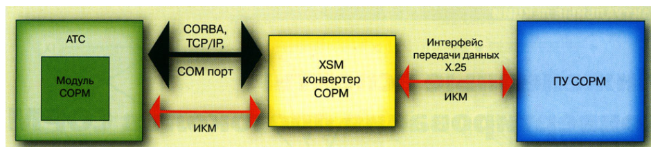
Рис. 2. Подключение конвертера XSM через цифровой интерфейс
